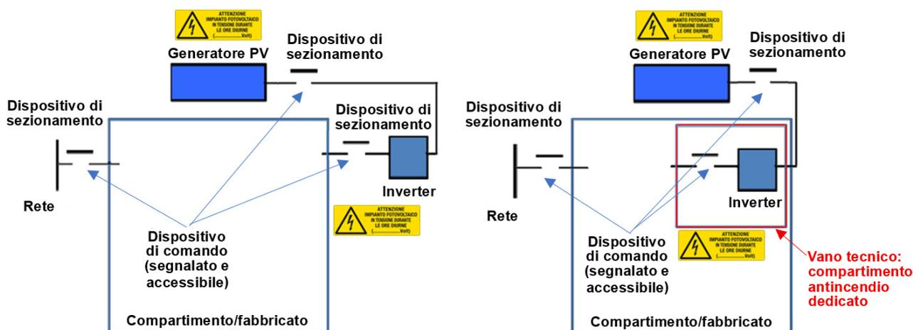
Figura 12 – Esempi di sezionamento di emergenza
